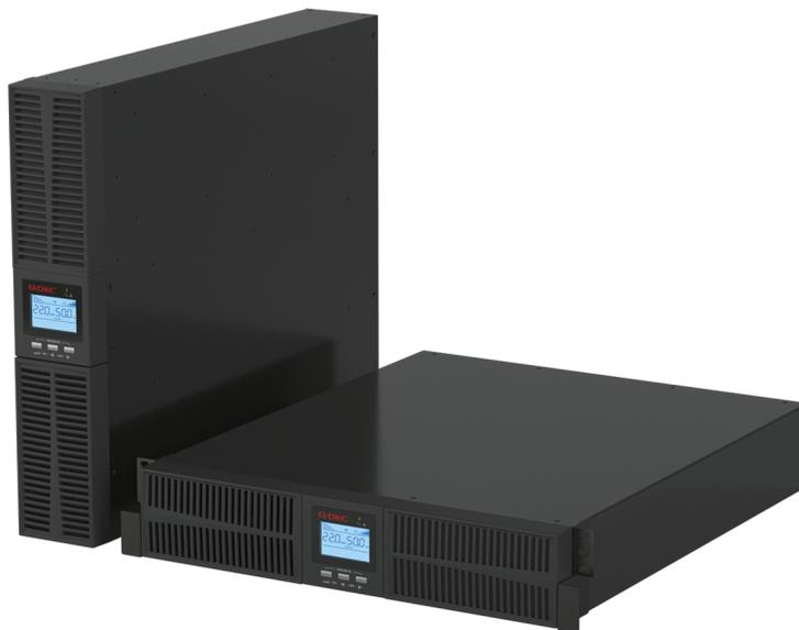
Info Rackmount Pro - серия однофазных линейно-интерактивных ИБП мощностью от 1 до 3 кВА. Устройства этого класса служат для обеспечения бесперебойной работы серверных небольшой мощности и локальных сетей. Помещаются в 19-дюймовую стойку, а также подходят для установки в напольные и навесные ИТ-шкафы 19" CQE глубиной от 400 мм (INFORPRO1000IN) до 600 мм (INFORPRO1500IN, INFORPRO2000IN, INFORPRO3000IN).
